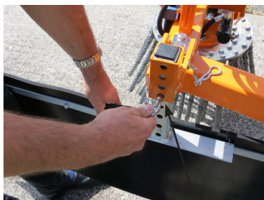
Avlägsna stiftet för gummiskärmen och demontera den.
