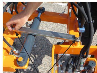
Avlägsna de två ringdelarna för styrstången och demontera den.
