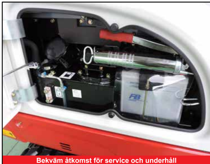
Stora låsbara serviceluckor ger åtkomst från marknivå
